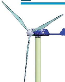
**SISTEMA DE CAPTACIÓN:** Es el encargado de transformar la energía del viento en energía de presión en un fluido. Está compuesto por un rotor eólico de aspa fija, una bomba hidráulica, un sistema de frenos de emergencia.
