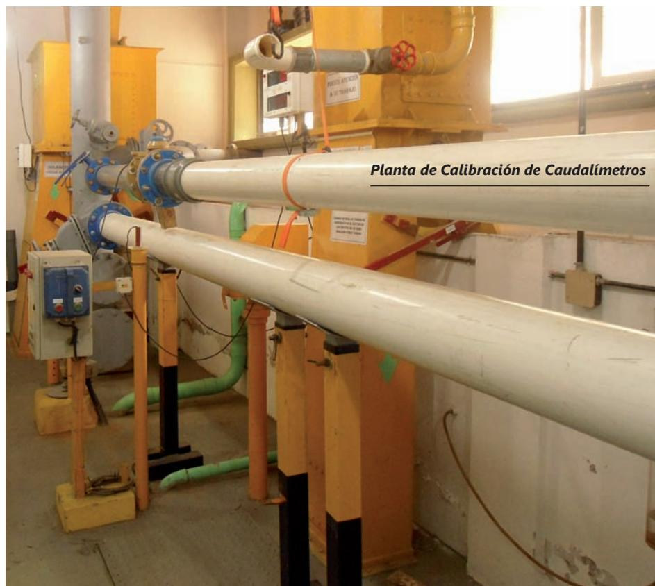
Planta de Calibración de Caudalímetros
