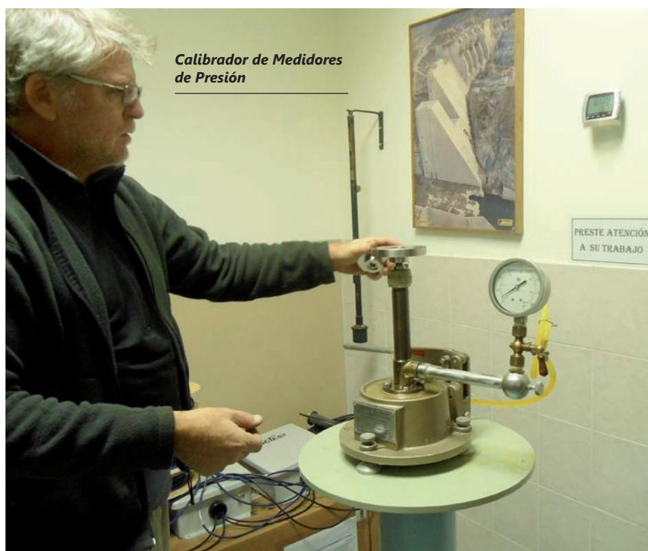
Calibrador de Medidores de Presión
